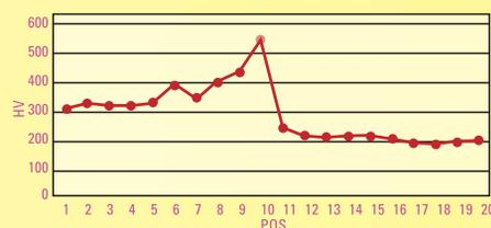
Come si può notare dalla mappatura nella zona termicamente alterata "POS.10" la durezza rilevata è superiore a quanto richiesto dalle normative. Per questo tipo di materiale la normativa è di 450HV max e rilevata 550HV (foto 2)
